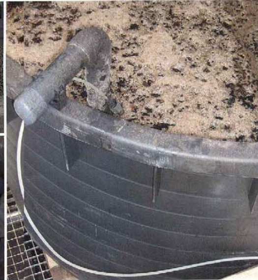
Het grootste extractievat is 1.000 liter. Hier deze Xtractor in werking met een doseerapparaat voor zonnebloemolie.
